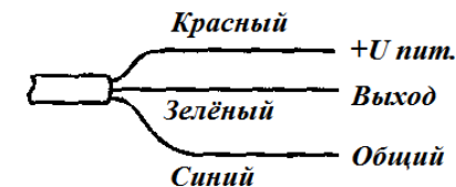
Рис. 3. Маркировка выводов и схема подключения датчика
